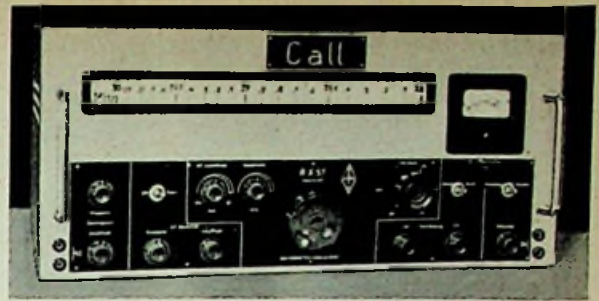
Bild 1. Die Frontplatte des Emp-fängers RX 57 mit dem Stations-Rufzeichen, der beleuchteten Wäl-zenskala, dem S-Meter und den übersichtlich beschrifteten Bedie-nungsorganen
