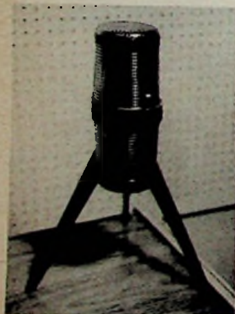
Eine interessante Mikrofon-Konstruktion, das Telefunken Mikrofon D 77 Stereo für zweikanalige Tonaufnahme. Es besteht aus einem ausgesuchten Pärchen von zwei Nierenkapseln. Sie sind von 60...180° drehbar. Durch Lösen einer Druckknopfverbindung können die beiden Kapseln bis auf eine Basisbreite von 2,40 m auseinandergestellt werden
