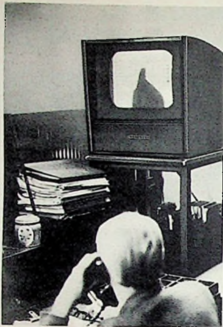
Empfangsgerät einer vereinfachten Fernseh-Übertragungsanlage im Zugverkehr. Die Hand weist auf eine Ankunftszeit einer im „Geber“ eingelegten Tabelle
